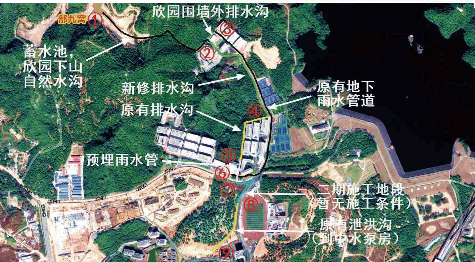
部九窝引水工程施工方案图
